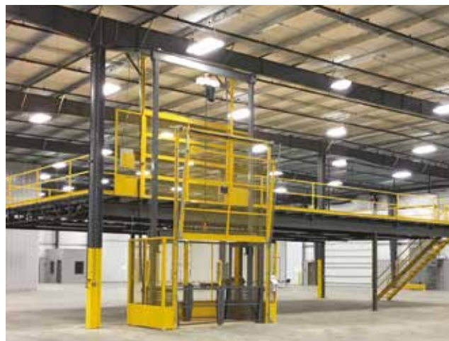
Lấy hàng thủ công kết hợp với thang máy Carry the cargo by using the elevator
