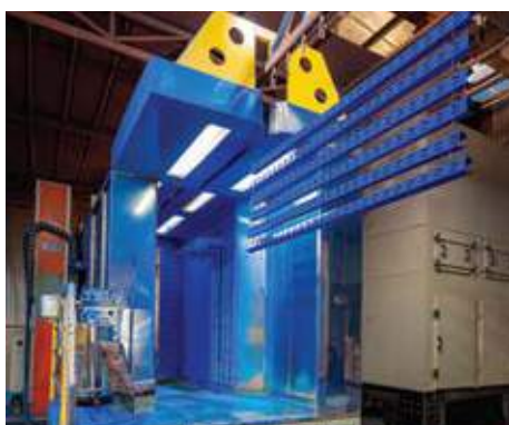
7. Dây chuyền sơn tĩnh điện Powder coating line
