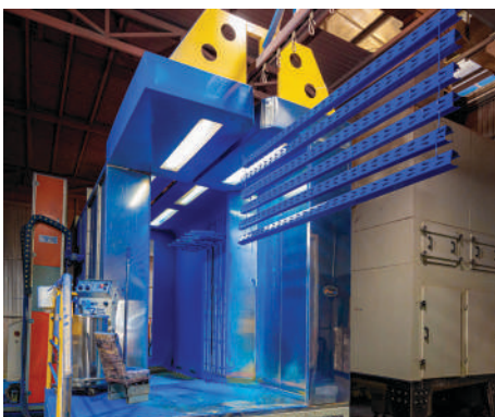
7. Dây chuyền sơn tĩnh điện Powder coating line
