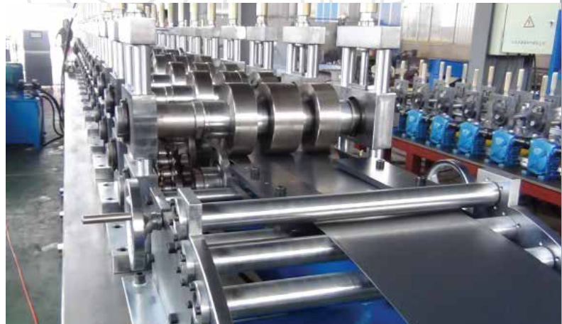
DÂY CHUYỀN CÁN TẠO HÌNH Steel Laminating Lines
