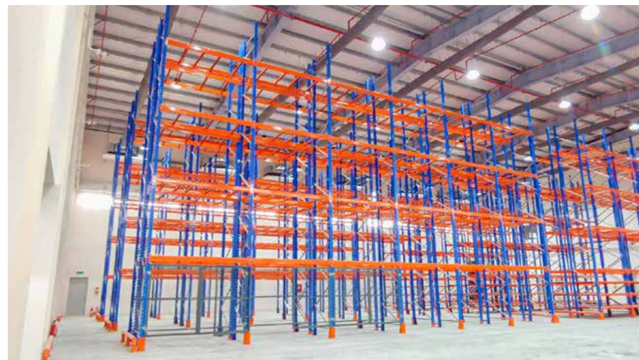
Dự án: Cty CP thiết bị dược Dapharco Đà Nẵng Project: Pharmaceutical Medical Equipment Joint Stock Company Hạng mục thi công: Kệ selective Works: Selective Rack
